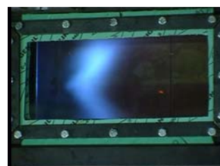
Details der Injektion, mit verschiedenen Drallwinkeln. Der Winkel des Flammenkegels, und ihre Stabilität ist abhängig von diesem Modul.
