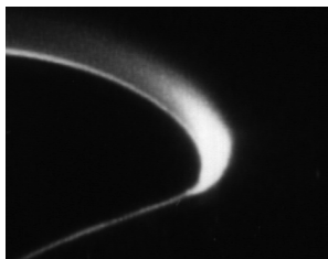
Abb.1: Schlierenvisualisierung des transsonischen Kühlstrahls an der Schaufelnase
